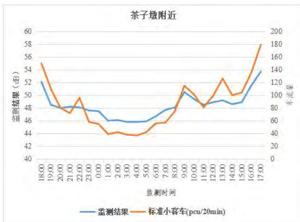
图 7.3-5 茶子墩附近交通噪声 24 小时连续监测结果曲线图
