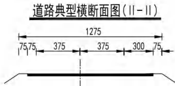
图 3.2-5 单向双车道（12.75m）匝道断面
