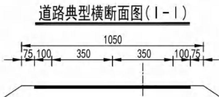
图 3.2-6 单向双车道（10.5m）匝道断面
