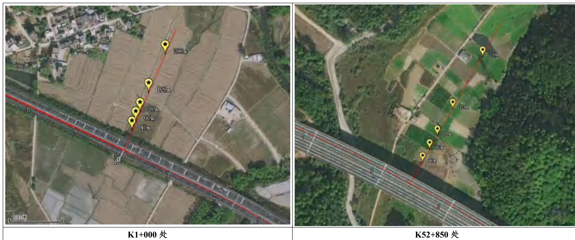
图 7.3-1 噪声衰减断面监测布点图
