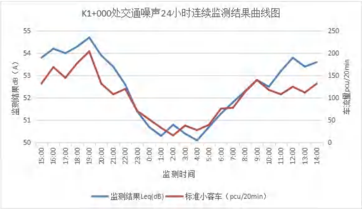
图 7.3-7 K1+000 处交通噪声 24 小时连续监测结果曲线图
