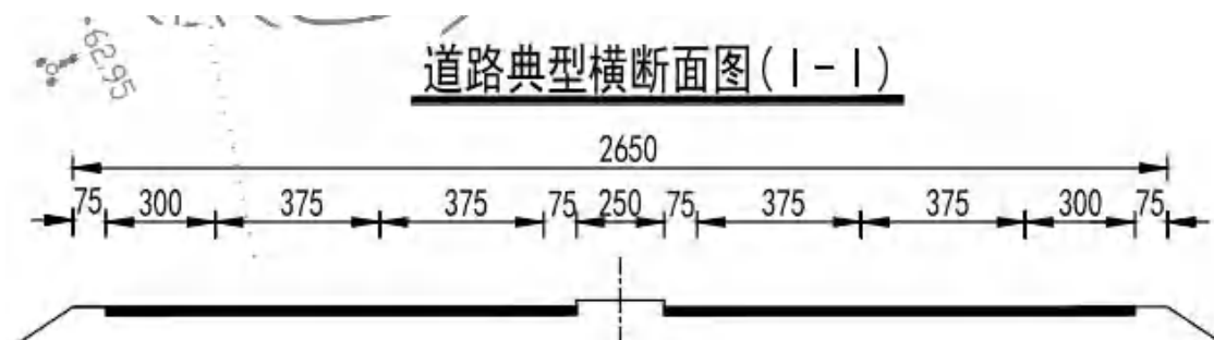
图 3.2-3 双向四车道（26.5m）匝道断面
