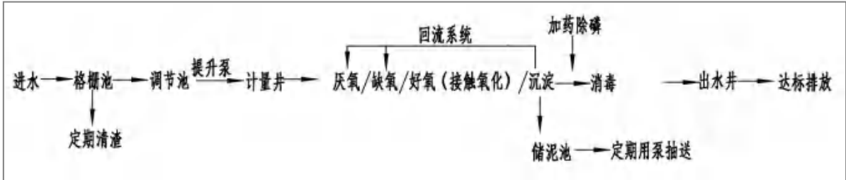
图 9.3-3 本项目管理中心、服务区生活污水处理工艺流程图
